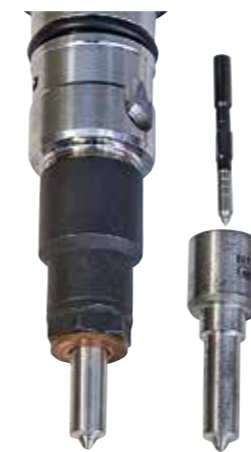
Gealterter Diesel kann zu Ablagerungen an der Düsennadel (innen) und den Einspritzöffnungen (außen) führen. Die Folgen sind eine unsaubere Verbrennung bis hin zum Totalausfall.
