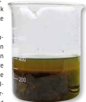
Die weit vorgeschrittene Dieselpest zeigt sich durch die dunkle Verfärbung und den Schlamm am Boden.
