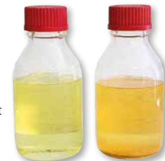
Hier ist die Alterung des Diesels bereits durch feste Bestandteile und die trübe Färbung in der Flasche rechts zu erkennen.
